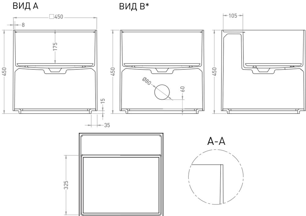
\* Расположение стандартного технологического отверстия на задней стенке. В базовую комплектацию не входит, заказывается отдельно.
